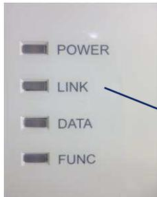
LINKランプの色にて電波の強度が確認できます。
