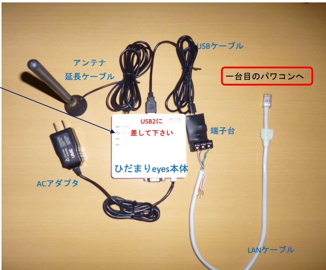
被膜を剥がしたネットワーク・ケーブルの線を順番に並べ、プラグの対応するピンに接続します。反対側を端子台へ下の表のように接続して下さい。
